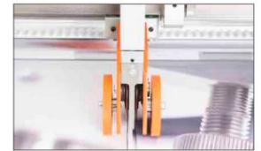
Cuchilla longitudinal de una sola hoja giratoria con rodamiento (doble hoja opcional)
