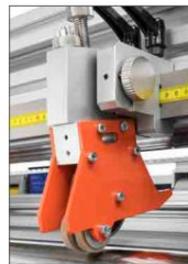
Cuchilla longitudinal compacta con hoja giratoria, simple o doble (opcional)
