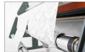
Sistema de rebobinado frontal: rebobina la bobina cortada hasta 3 canillas más pequeñas (opcional para Miura Plus 160)
