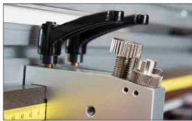
Tornillo de ajuste de presión de la hoja a utilizar según el tipo de material a cortar
