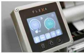
Panel de control para alineación vertical automática.
